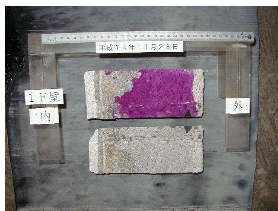
コンクリートの中性化試験
