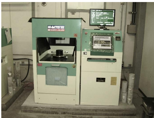
硬化コンクリートの圧縮強度試験
