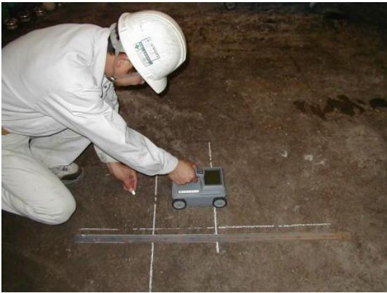
鉄筋の配筋 及び かぶり厚調査
