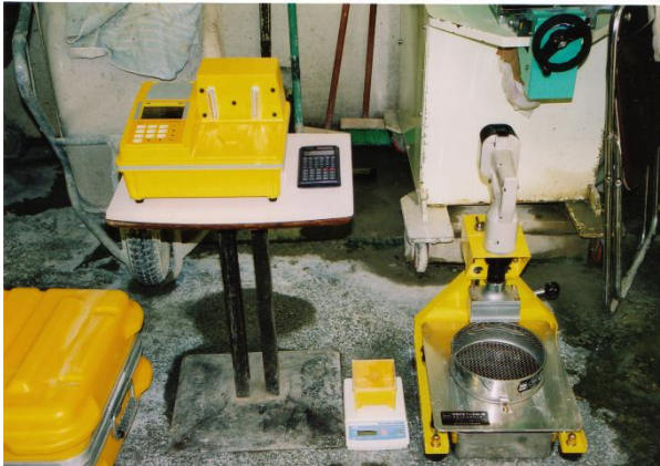
フレッシュコンクリートの単位水量試験
