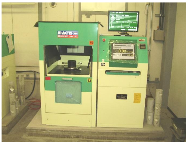
硬化コンクリートの圧縮強度試験
