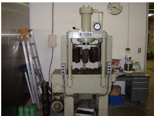
・ 曲げ試験機鉄筋
