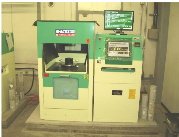
硬化コンクリートの圧縮強度試験
