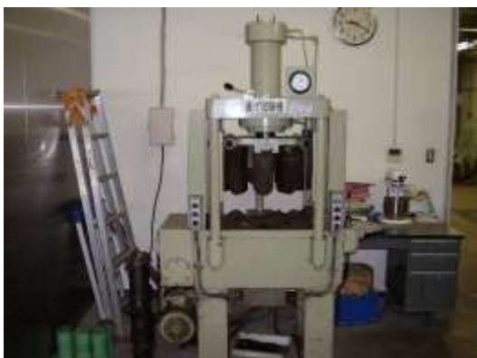
・ 曲げ試験機鉄筋
