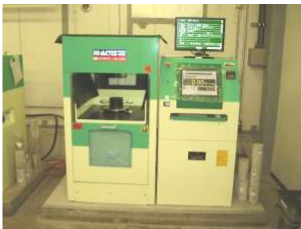
硬化コンクリートの圧縮強度試験
